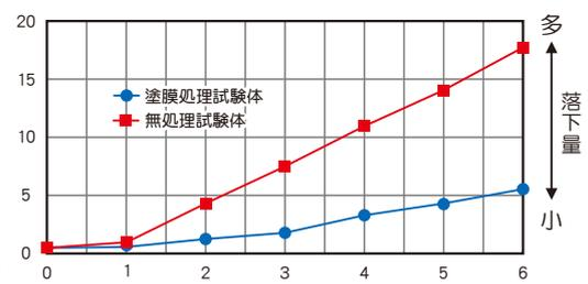
(財)日本建築総合試験場において無処理ガラス(表:赤線)とトドマール処理ガラス(表:緑線)で結露の落下水量測定試験を実施したところ、トドマールは結露垂れを71%抑制することが立証されました。また同試験場において熱移動を抑制する効果があることも立証されました。
